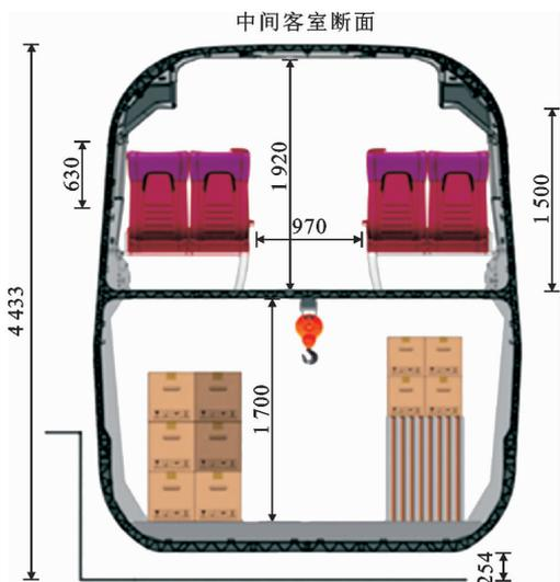
图2 新型双层餐客货两用车切面图
